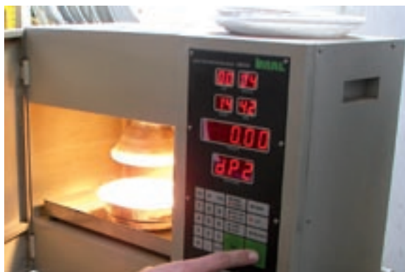
FOTO 3.5 – BILANCIA A INFRAROSSI IMPIEGATA PER LA DETERMINAZIONE DEL CONTENUTO IDRICO DEL CIPPATO DI VITE.
