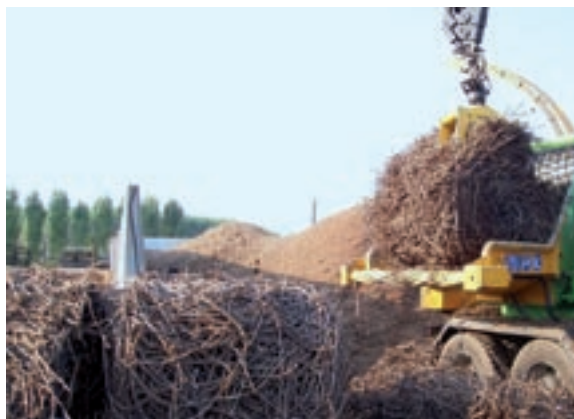
FOTO 4.10 – PARTICOLARE DELLA FASE DI CIPPATURA.
