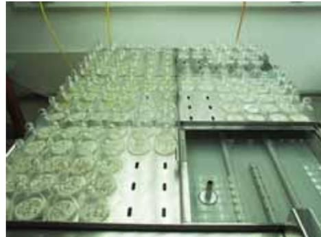
Foto 12.6. Test di germinabilità di singole specie in apparato Jacobsen (Haslgrübler).
