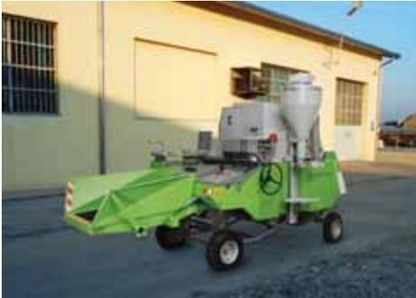
Foto 7.5. Con una trebbiatrice stazionaria, il fieno già trasportato in azienda può essere trebbiato prima del suo utilizzo come foraggio. Tuttavia, a causa delle perdite di semi sia durante la fienagione sia durante la trebbiatura, l'efficienza complessiva è bassa (wintersteiger.com, modificata).
