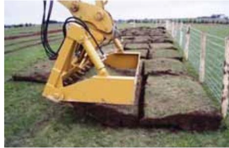
Foto 7.12. Per ottenere zolle di grandi dimensioni può essere utilizzato uno scavatore modificato, in cui la benna è sostituita da una speciale pala macro zollatrice ([www.huckbody.com](http://www.huckbody.com)).
