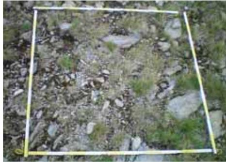
Foto 11.12. Quando è previsto un monitoraggio di lunga durata dopo il restauro, come in questo suolo molto pietroso, il posizionamento di plot fissi di campionamento (i vertici dei plot sono indicati con picchetti metallici colorati di giallo) è utile per meglio valutare l'evoluzione della vegetazione (M. Scotton).
