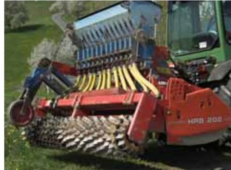
Foto 10.1. Per un buon esito dell'intervento, dopo la semina a secco è importante l'uso di un rullo corrugato (W. Graiss).
