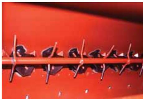
Foto 10.8. Semplici adattamenti, come il montaggio di un secondo albero contro-rotante di miscelazione e di piccoli pezzi di pelle, consentono di usare le attrezzature di semina convenzionali anche per miscugli non omogenei e con scarsa capacità di flusso (B. Krautzer).
