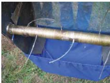
Foto 7.7. Particolare di una spazzolatrice di seme portatile (M. Ševčíková).
