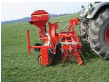
Foto 10.9. Attrezzatura per trasemina con erpice potente, tramoggia per seme e rullo corrugato (E.M. Pötsch).
