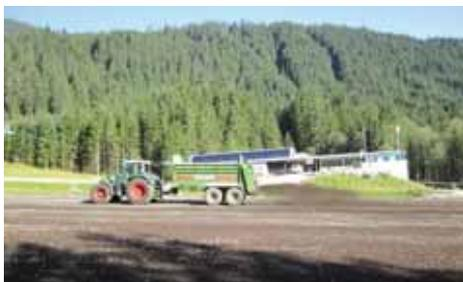
Foto 10.34. Gli spargitori di compost sono molto adatti per la distribuzione uniforme sull'area da restaurare di suolo ricco di propaguli proveniente da siti donatori (E. Urstöger).
