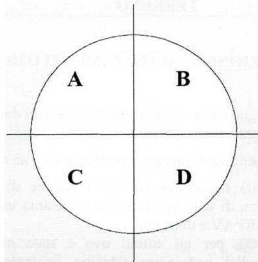
Il campione finale da inviare al laboratorio sarà costituito da quattro parti, prelevate rispettivamente dalle porzioni A, B, C e D, di peso pari, ciascuna, a 0,5 kg, per un totale pari a 2 kg .
