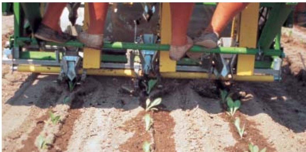
Fig. 9 - Trapianto di piantine con pane di terra con trapiantarice dotata di dispositivo di irrigazione localizzata (particolare)
