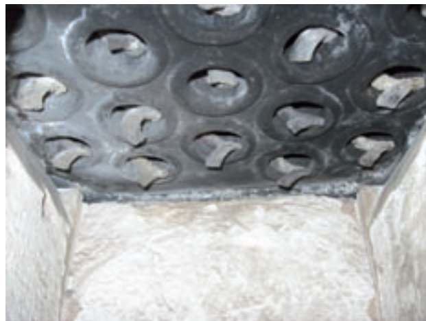
Figura 6.7: parte inferiore degli scambiatori di calore prima del test di combustione, rispettivamente con pellet di canna comune (sinistra) e miscanto (destra).
