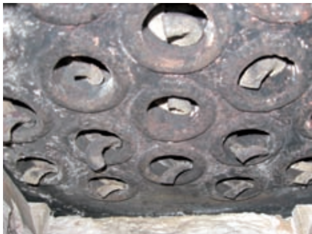
Figura 6.7: parte inferiore degli scambiatori di calore prima del test di combustione, rispettivamente con pellet di canna comune (sinistra) e miscanto (destra).
