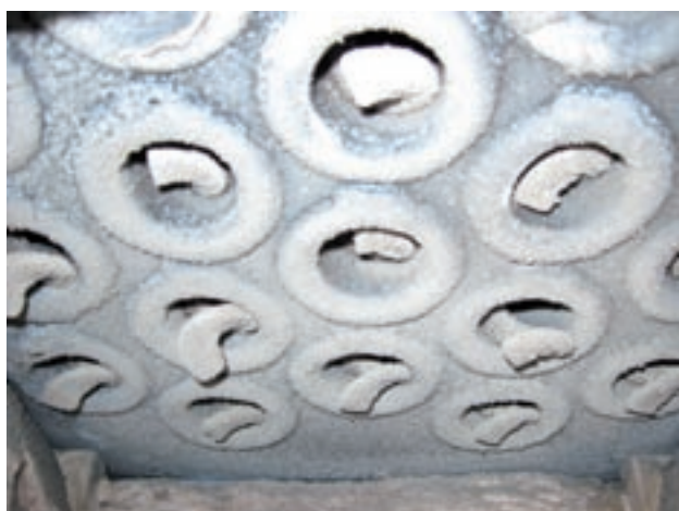
Figura 6.8: parte inferiore degli scambiatori di calore dopo il test di combustione, rispettivamente con pellet di canna comune (sinistra) e miscanto (destra).
