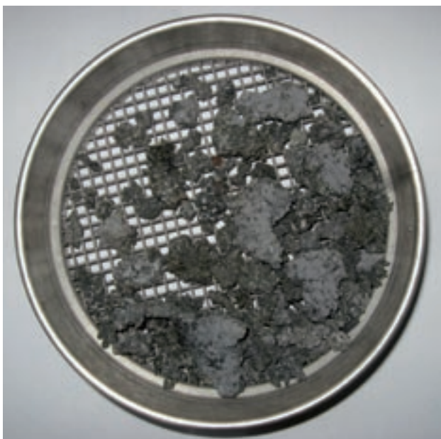
Figura 6.11: grumi di materiale e scorie fuse dopo la vagliatura (5,6 mm) delle ceneri di canna comune (sinistra) e di miscanto (destra).
