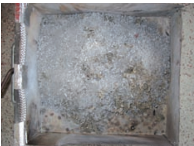
Figura 6.10: box di raccolta delle ceneri fini, con presenza di particelle grossolane e scorie fuse, al termine del test di combustione del pellet di miscanto.
