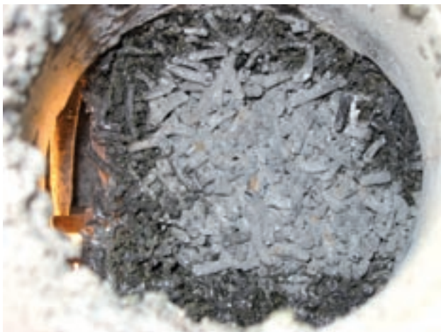
Figura 6.9: ceneri e scorie fuse accumulate sulla griglia al termine del test di combustione, rispettivamente del pellet di canna comune (sinistra) e miscanto (destra).
