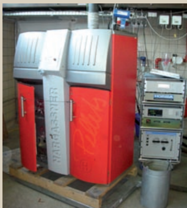
Figura 6.5: caldaia innovativa utilizzata per i test di combustione presso " Austrian Bioenergy Centre " di Graz.
