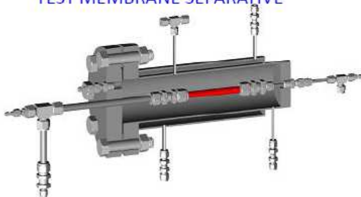
IMPIANTO SPERIMENTALE PER TEST MEMBRANE SEPARATIVE
