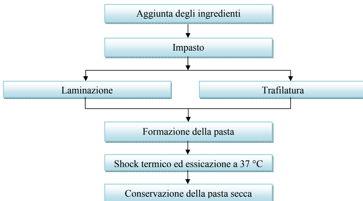
Figura 9.1 Diagramma di flusso della produzione della pasta per paste cilindriche e piatte (Diàz, 2006)
