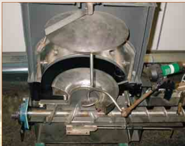
Foto 14. Particolare della camera di combustione
