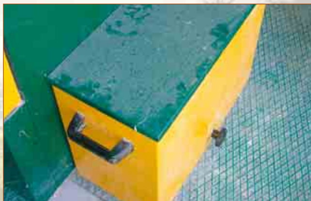
Foto 17. Cassetto estraibile per la rimozione delle ceneri
