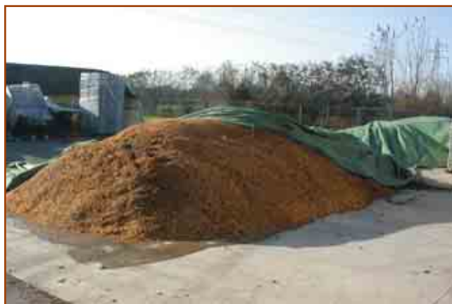
Foto 10. Stoccaggio all'aperto del cippato con copertura mediante telo traspirante
