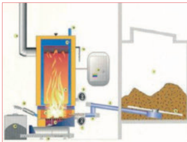
Figura 4.1. Schema di una caldaia a cippato a griglia fissa. Fonte: AIEL – Associazione Italiana per le Energie Agro-forestali.
