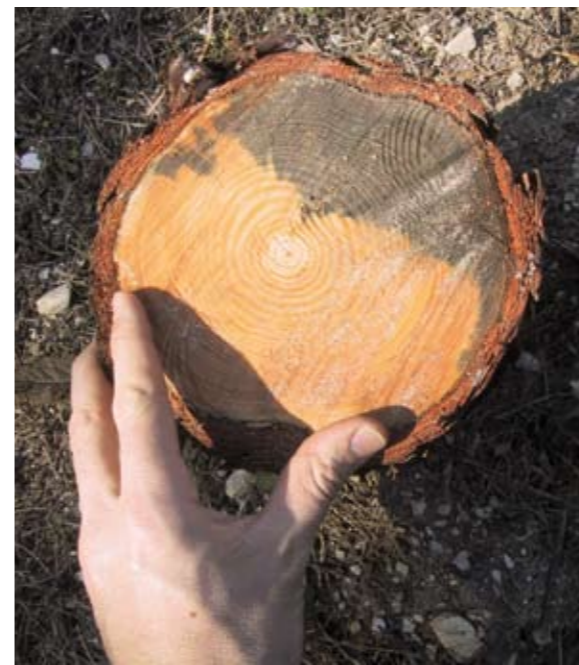
Sezione di un tronco di pino con presenza di funghi cromogeni Regione Veneto Servizi Fitosanitari
