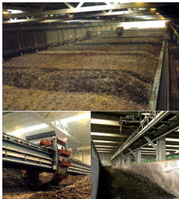
Figura 3.17 – Bacino (foto 1 e 2) e corsia (foto 3) di biossidazione
