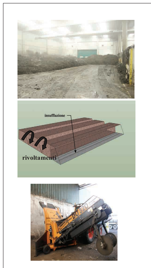
Figura 3.16 – Esempi di platea insufflata e di rivoltatrice utilizzata per questa tipologia di trattamento
