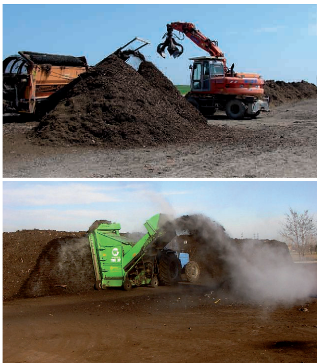
Figura 3.19 – Gestione del processo di compostaggio all'aperto
