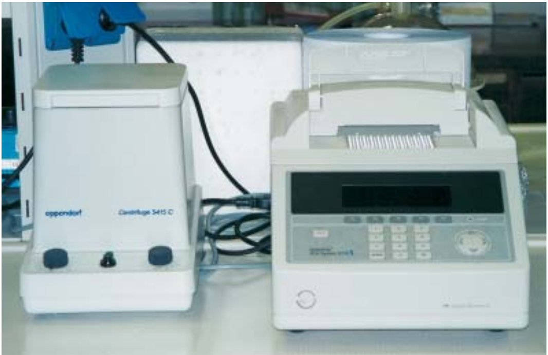
Fig. 18 – Termociclotone (a destra). L'apparecchio serve ad amplificare tratti di DNA identificabili come marcatori RAPD, I-SSR, AP-PCR, in seguito a separazione mediante elettroforesi su gel di agarosio.
