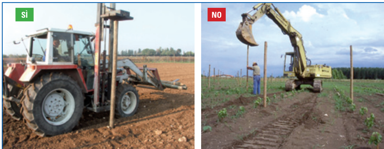
Figura 18. Procedura corretta (a sinistra) di messa a dimora del palo con macchina specifica e procedura non consentita (a destra) con benna di macchina per movimento terra
