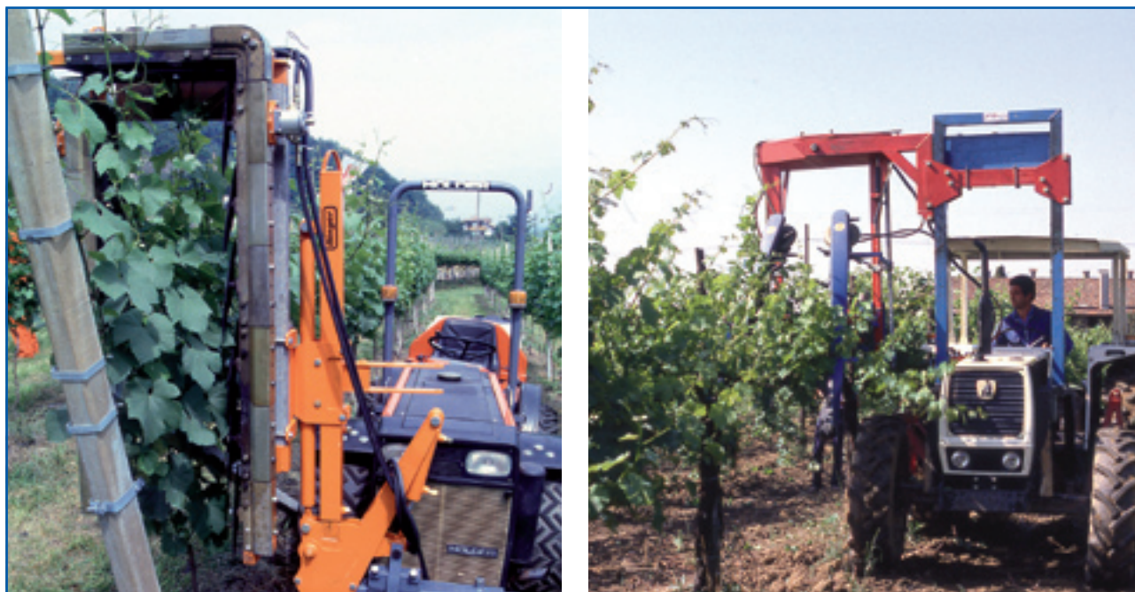
Figura 27. Cantieri di lavoro di cimatura (a sinistra) e legatura (a destra)
