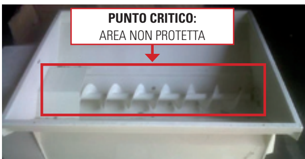
Figura 51. Area non protetta nella bocca di una pigiadiraspatrice
