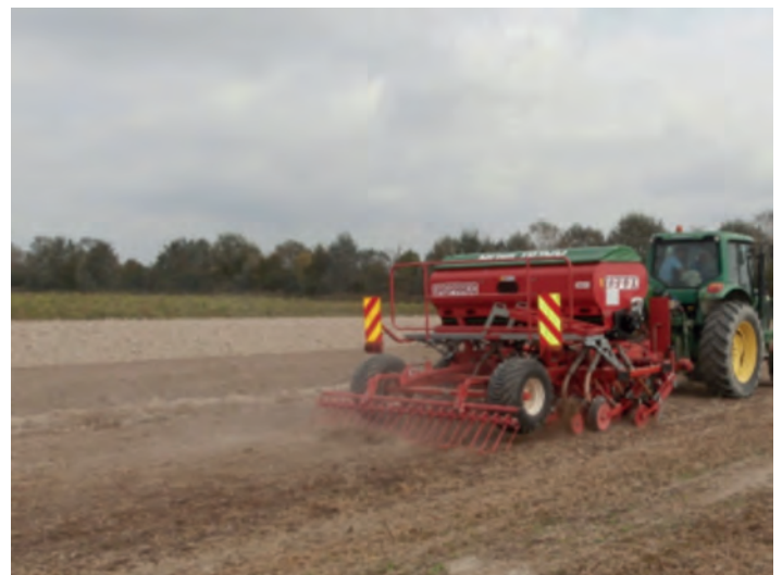
Figura 2 - La tecnica prevede la lavorazione solamente nella zona interessata dal solco di semina. Poiché la maggior parte della massa del terreno rimane praticamente indisturbata, i residui della coltura precedente rimangono integralmente in superficie.
