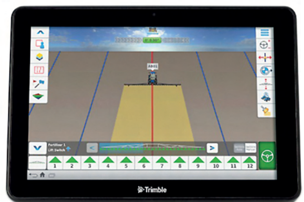
Figura 2 - Particolare di un sistema di controllo applicato una trattoria dotata di sistema di guida semi-automatica
