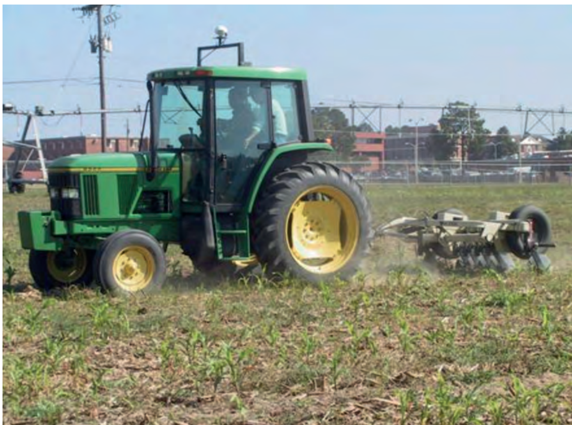
Figura 3 - Esempio di sensore ad induzione elettromagnetica EMI
