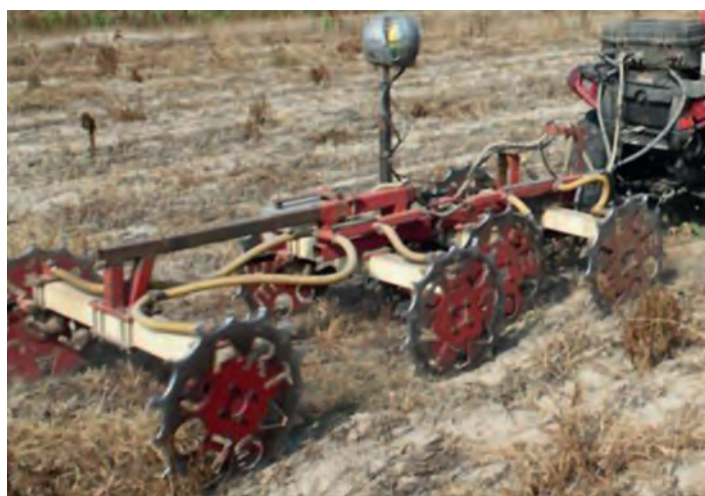
Figura 1 - Georesistivimetro dotato di ricevitore satellitare. L'analisi non invasiva attuata da questo strumento viene eseguita in velocità su tutto il campo e restituita sotto forma di mappa georeferenziata.
