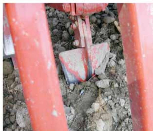
La vangatrice solleva la zolla dal terreno senza formare la suola di lavorazione.
