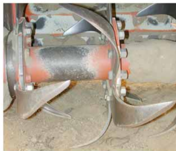
Gli organi lavoranti della fresa lisciano il terreno formando la suola di lavorazione.
