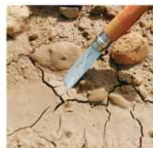
Terreno medio con scheletro, povero di sostanze cementanti, prima e dopo un'irrigazione eseguita con un'attrezzatura troppo potente.
