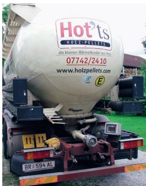
Foto 2 - Camion per la distribuzione a domicilio del pellet da legno.
