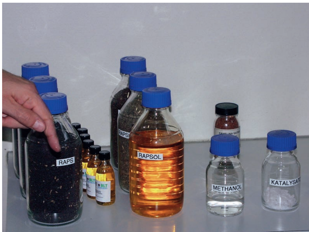
Foto 3 - Produzione di biodiesel: i materiali necessari. Da sinistra: semi di diverse oleaginose, oli derivati dalla spremitura, metanolo e catalizzatore (NaOH).
