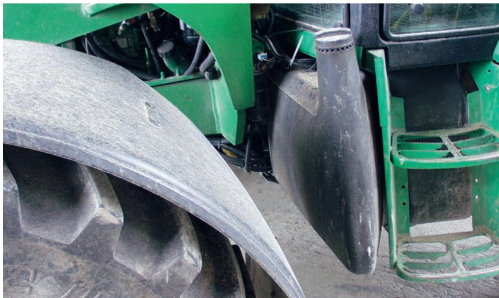
Foto 4 - Serbatoio aggiuntivo in un trattore modificato per permettere l'utilizzo diretto dell'olio vegetale.
