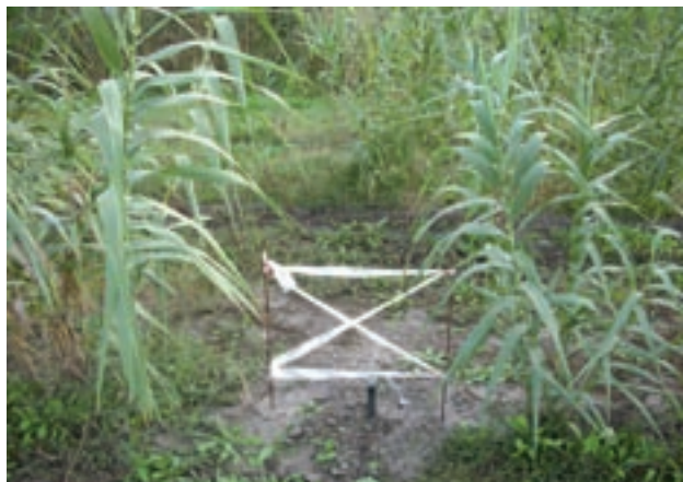
Figura 4.1: unità lisimetrica presso una parcella a canna comune (sopra) e pioppo (sotto).
