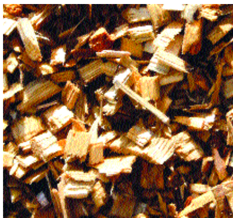
Fig. 1.3.1: foto di cippato, ove sono ben visibili i chips e le relative dimensioni
