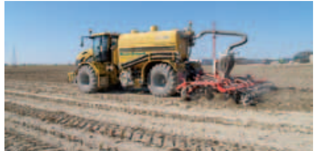
Figura 11 – Il mezzo semovente ha capacità di lavoro più alta e minor impatto ambientale rispetto alle altre soluzioni. La sua adozione si può prospettare nel caso di considerevoli quantità da distribuire annualmente, con liquame concentrato e basse dosi di distribuzione
