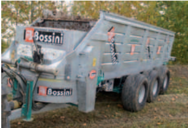
Figura 6 - Con attrezzature di elevata capacità la distanza limite per il cantiere riunito si aggira attorno ai 13-20 km in funzione del tipo di materiale, superati i quali conviene utilizzare i cantieri separati
