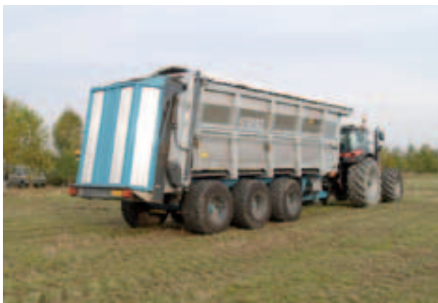
Figura 6 - Con attrezzature di elevata capacità la distanza limite per il cantiere riunito si aggira attorno ai 13-20 km in funzione del tipo di materiale, superati i quali conviene utilizzare i cantieri separati
