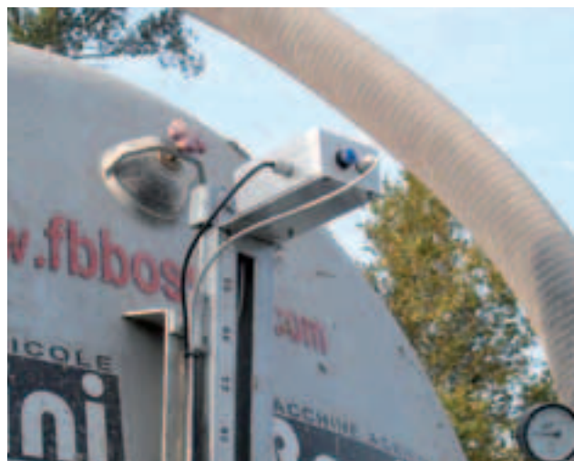
Figura 16 – Particolare del sistema di localizzazione installato sul carrobotte
