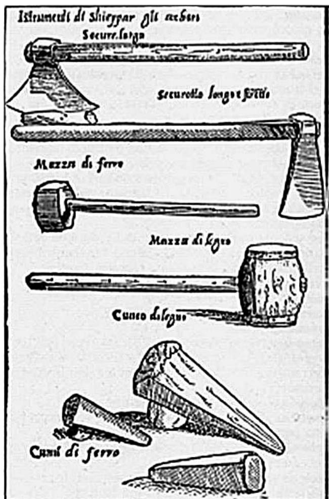
Attrezzi per ricavare steli di spacco dai fusti, "Dai monti alla laguna".
