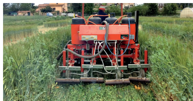
Figura 2 - Macchina per il pirodiserbo utilizzata per devitalizzare la cover crop subito dopo la rullatura
