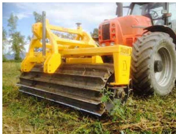
Figura 13 – Il DONDI Cut-roller, versione originale (foto di Christian Frasconi)
