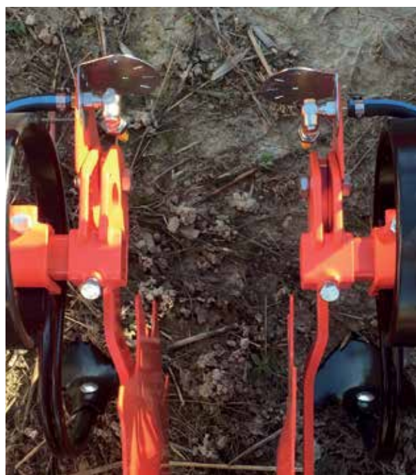
Figura 4 - Ugelli per il diserbo localizzato montati sul telaio della sarchiatrice
