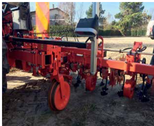
Figura 3 - Visore ottico per il riconoscimento delle file della coltura
