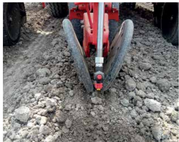
Figura 6B - Dettaglio dell'ugello montato sulla seminatrice
