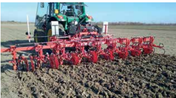
Figura 2 - Prototipo della sarchiatrice equipaggiata con ugelli per il diserbo localizzato utilizzata nella prova
