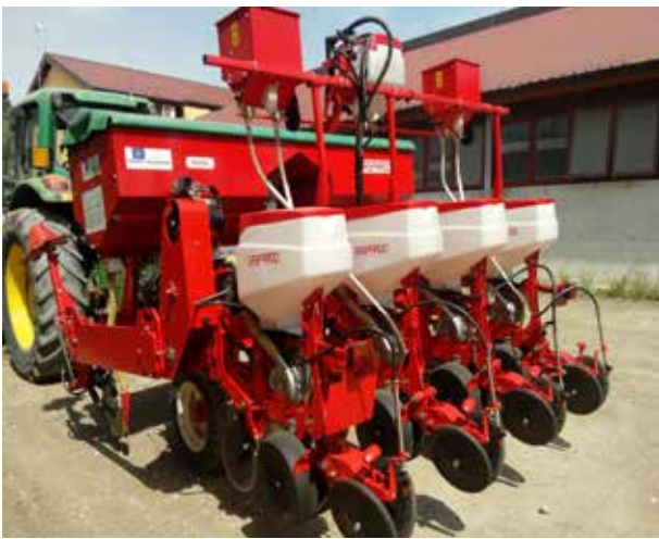
Figura 1 - Seminatrice equipaggiata con ugelli per il diserbo localizzato utilizzata nella prova
