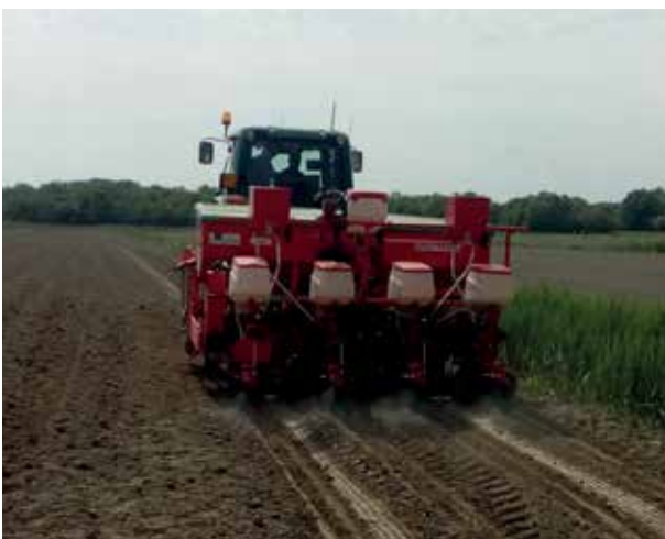
Figura 6A - Semina del mais con diserbo localizzato lungo la fila
