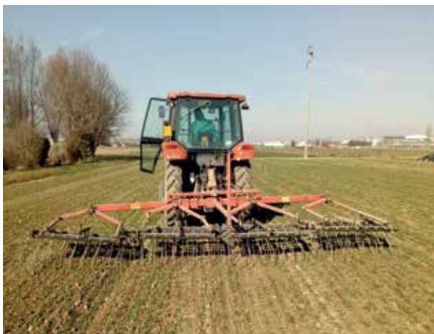
Figura 2 – Passaggio con erpice strigliatore dopo la trasemina del trifoglio nel frumento (Febbraio 2019)
