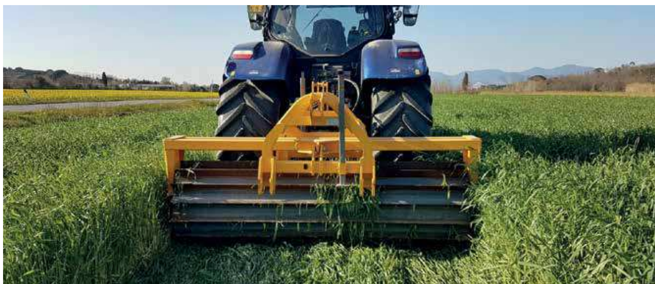
Figura 2 - Devitalizzazione della segale in fase vegetativa con rullo-trincia Dondi nel 2019 (primo passaggio, 28 Marzo 2019)
