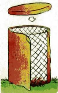
permettere all'aria di circolare nel materiale in trasformazione, sfruttando l'effetto camino per cui l'aria calda e povera di ossigeno uscendo dal coperchio del composter richiama l'aria fresca e ricca di ossigeno dalle fessure alla base dello stesso. Ricordiamo che il processo di
