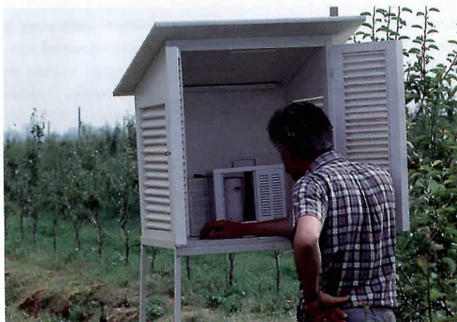
Foto 9. In pieno campo sarebbe bene che il termoigrografo fosse posizionato all'interno di un'apposita capannina
