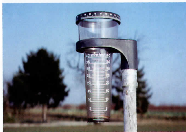
Foto 10. Il pluviometro è un attrezzo semplicissimo che fornisce informazioni utili per la gestione dei trattamenti antiparassitari e la previsione degli attacchi fungini
