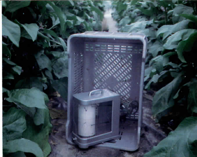
Foto 8. Nelle colture protette l'uso del termoigrografo è fondamentale, in particolare nella prevenzione degli attacchi fungini e quando si usano insetti ed acari utili
