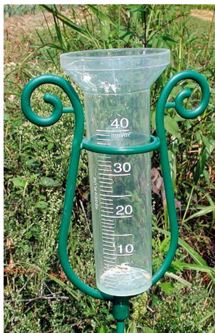
Il pluviometro è uno strumento semplice che permette di rilevare la piovosità: va sistemato all'aperto, in una zona priva di ostacoli o barriere, rilevando i dati dopo ogni pioggia
