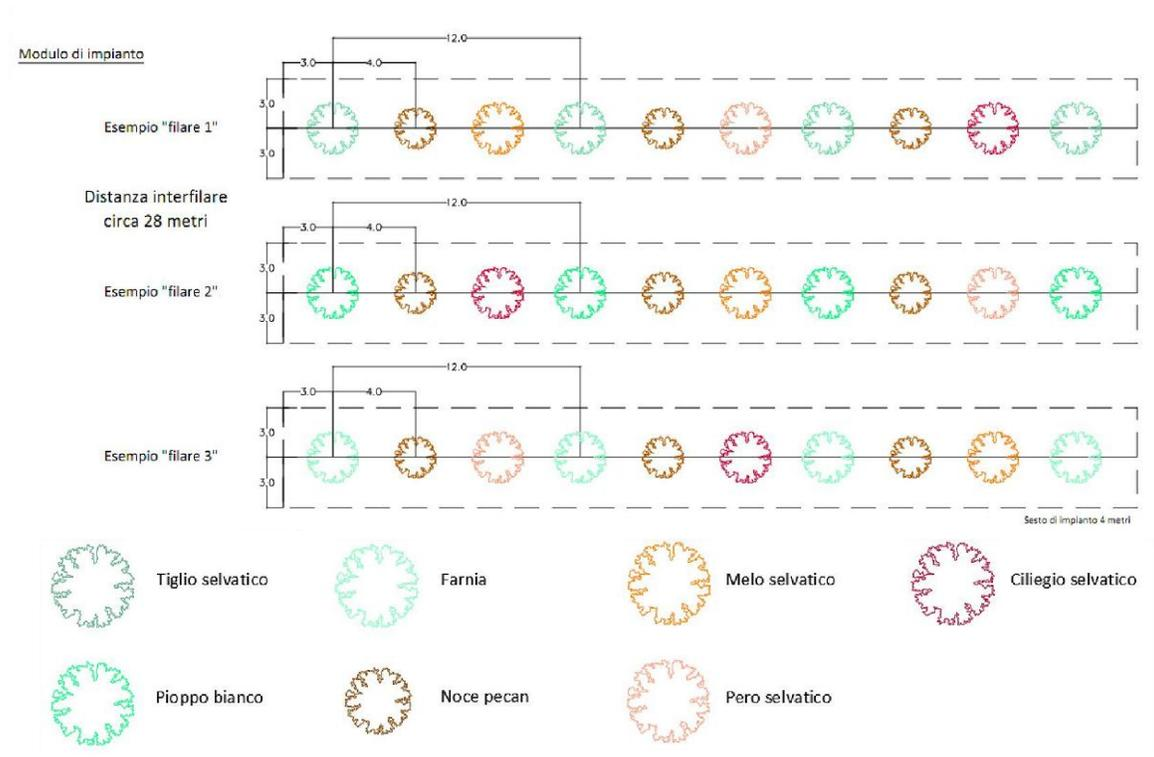
Il modulo di impianto previsto prevede un sesto di 4 m sul filare arborato e 28 m tra i filari (fascia a seminativo). Il modulo d'impianto è stato progettato garantendo la fascia di tre metri a partire dalla parte basale esterna del fusto delle piante perimetrali dell'impianto. La densità dell'impianto risulta di 83 piante/ha.
