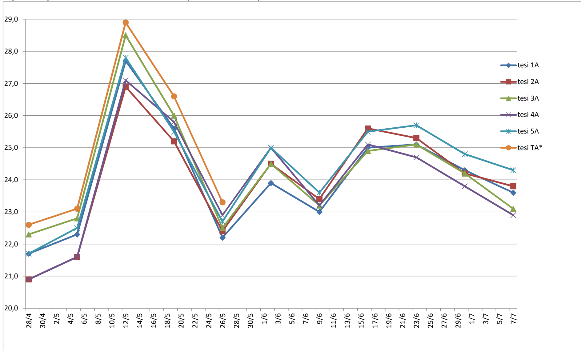
Fig. 9 - Temperature medie settimanali a 10 cm di profondità sotto la pacciamatura
