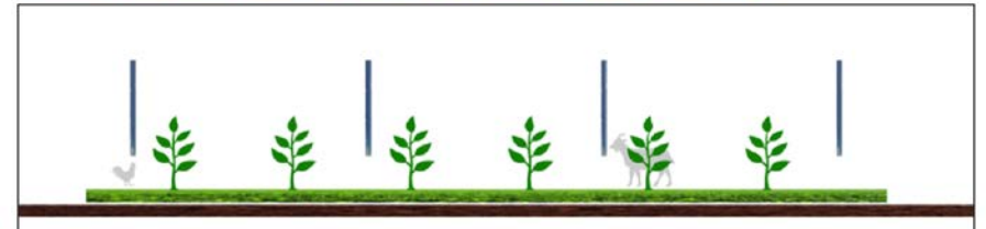
Figura 11 - Sistema agrivoltaico in cui i moduli fotovoltaici sono disposti verticalmente. La coltivazione avviene tra le file dei moduli fotovoltaici, l'altezza minima dei moduli da terra influenza il possibile passaggio di animali (TIPO 3).
