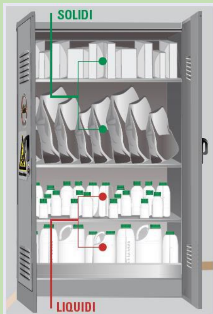
Corretto posizionamento dei PF all'interno di un armadio a norma.
